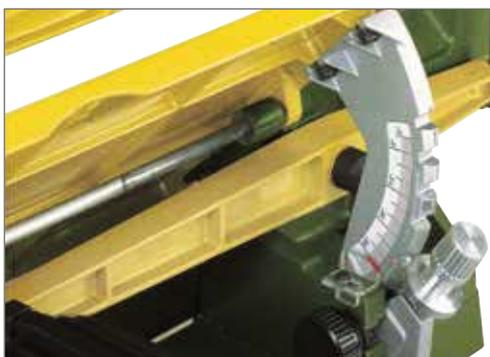
**Tisch-Schrägverstellung von -5 bis 50° möglich.** Mit großdimensionierter Rastung bei 0°, 10°, 20°, 30° und 45°. Zusätzliche Feineinstellung. Für präzise Gehrungs- und Winkelschnitte.
