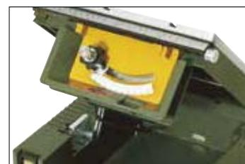
Tisch und Antrieb können wie eine Motorhaube hochgeklappt und verrastet werden. Zum Reinigen des Gerätes und für problemlosen Sägeblatt-Wechsel.
