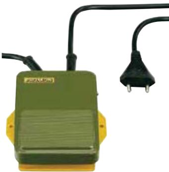
Für alle Geräte mit Euro-Stecker (Schutzklasse 2) und einer Leistung bis max. 500 W. Auch für Tischgeräte geeignet. Gehäuse aus glasfaserverstärktem NYLON. 250 cm-Anschlusskabel zum 230 V-Netz. 50 cm-Kabelausgang. Bei 12 V-Geräten wird der Fußschalter am Netzgerät angeschlossen.
