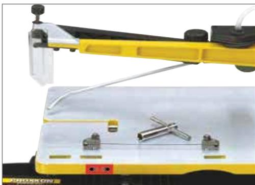
**Patenterte Kulissensteine mit hoher Spannkraft** sorgen für genau fluchtende Sägeblätter. Ausnehmungen in der Tischoberfläche fixieren Position und Distanz der Kulissensteine und erleichtern die Montage des Sägeblattes.
