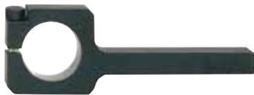
Aus Stahl mit 20 mm-MICROMOT-Systempassung. Für präzises Einspannen der Bohrschleifer IBS/E oder LBS/E im Stahlhalter der Drehmaschine. Schaftmaß 8 x 10 mm. Gesamtlänge 65 mm.
