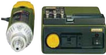
Maximale Leistungsaufnahme 250 W. Spindel-drehzahlen stufenlos regelbar von 900 – 6.000/min. Gewicht 4,2 kg. Mit Spannzangen Größe 2,35 – 3 – 3,2 – 4 – 5 und 6 mm. Dazu zwei Spannschlüssel.
