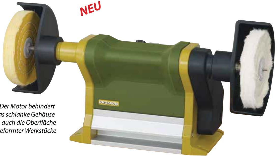
Wellenantrieb über Zahnriemen: Der Motor behindert nicht mehr den Arbeitsbereich. Das schlanke Gehäuse um die Hauptwelle ermöglicht es, auch die Oberfläche sehr langer und unterschiedlich geformter Werkstücke zu bearbeiten.
