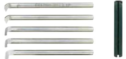
Gewindedrehstahl metrisch 60° und whitworth 55°. Je 1 Stück Einstechstahl 1,3 – 2,65 und 4 mm. Schaftdurchmesser 6 mm. Gesamtlänge 95 mm. Die Drehstäbe werden in den mitgelieferten Halter (8 x 8 mm) eingeschoben und im Stahlhalter der PD 230/E, PD 250/E oder PD 400 geklemmt. Im Holzkästchen mit Schiebedeckel.
