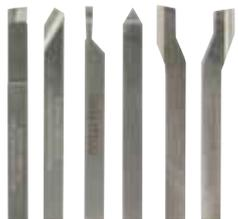
Ausdrehstahl, Schruppstahl, Abstechstahl, Spitzstahl (auch zum Schlichten), Seitenstahl rechts und Seitenstahl links.
