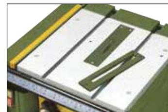
Ungeschlitzte Sägespalt-Abdeckung aus ABS für engste Toleranzen zwischen Sägeblatt und Tisch (wird von unten durch das Sägeblatt der FET geschlitzt). Zum Trennen kleinster Teile.
