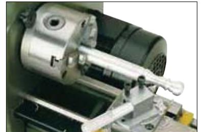
**Gerätehalter zum Rundschleifen auf Drehmaschinen**
