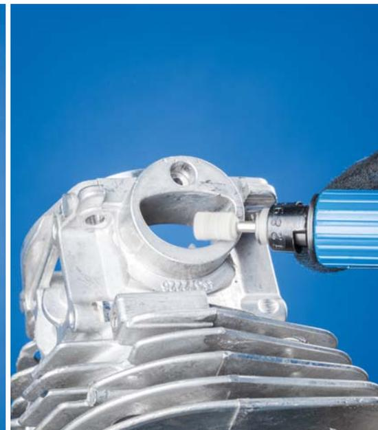
Les limes à liant vitrifié se composent de fibres céramique d'excellente qualité insérées et orientées dans un liant spécial à base de résine synthétique. Elles se prêtent à l'usinage de surfaces et de zones difficiles d'accès dans la fabrication d'outils et de moules.
