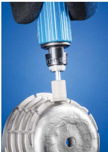
Les outils de ponçage fin Poliflex réalisés dans le liant LR sont fabriqués avec du corindon supérieur blanc. Le liant LR est dur et résistant. Conçus pour une utilisation sur les surfaces.
