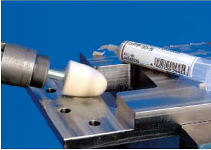
Les pâtes à polir diamant sont utilisées pour le polissage de matériaux très durs, par ex. carbure et aciers trempés. Elles sont utilisées avec des outils ou des disques de polissage en feutre. Les pâtes à polir diamant peuvent être diluées dans l'eau et l'alcool dans lesquels elles sont solubles.
