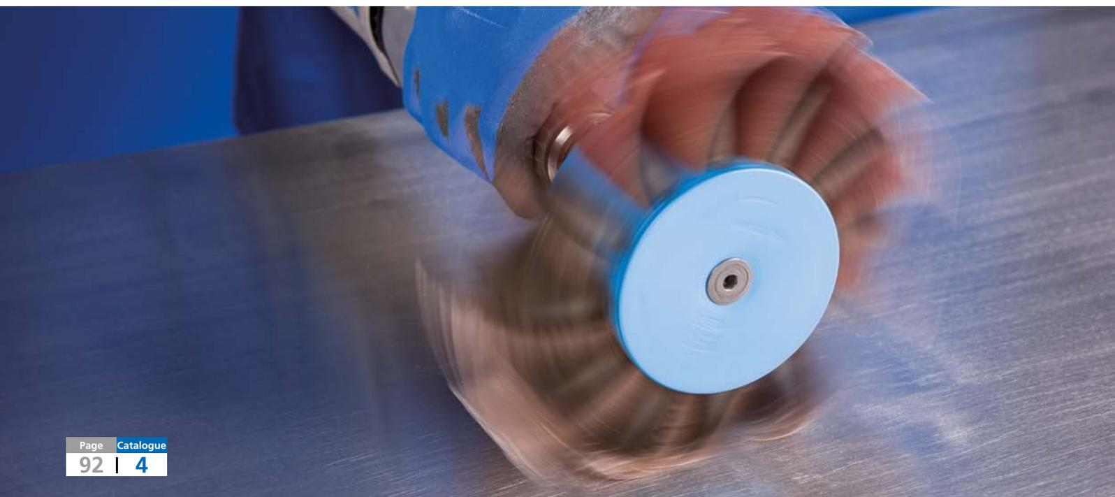
Les coussinets de ponçage sont parfaits pour le ponçage latéral.
