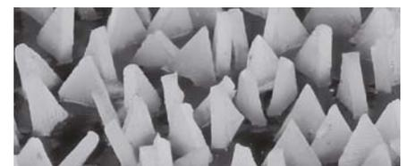
Orientation optimale du grain abrasif **VICTOGRAIN**
