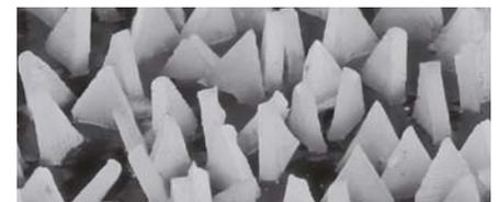
Orientation optimale du grain abrasif **VICTOGRAIN**
