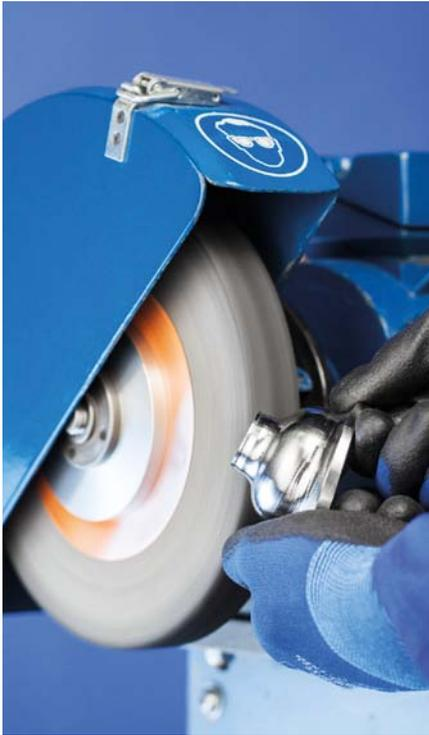
Les roues abrasives compactes POLINOX PNK se composent d'un non-tissé (Vlies) abrasif enroulé autour d'un noyau et moussé. La mousse protège le non-tissé et prolonge sa durée de vie tout en modifiant ses propriétés abrasives.
