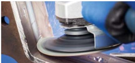
Meulage frontal particulièrement tendre et flexible avec les disques fibre de  $\varnothing$  125 mm.
