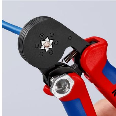
Enorme Kapazität: Crimpen von Einzeladern bis zu 16 mm<sup>2</sup> oder Doppeladern bis zu 2 x 10 mm<sup>2</sup>
