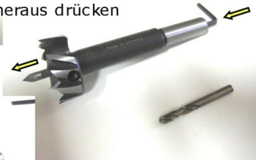
3. Vorbohrer bis zum Anschlag in die Aufnahmebohrung einführen
