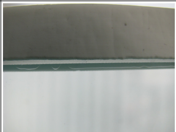
Bild 4 lange Blasen im Gutmuster
