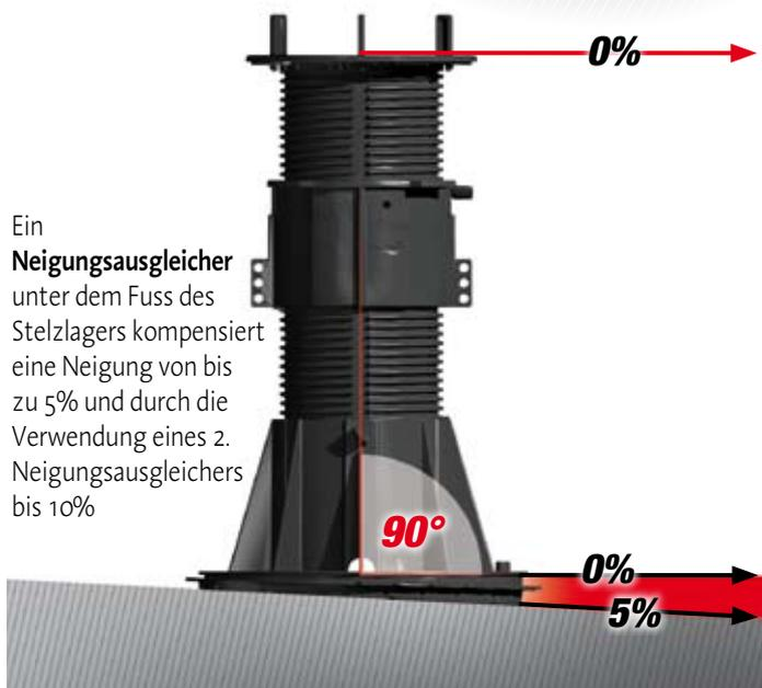
Ein **Neigungsausgleicher** unter dem Fuss des Stelzlagers kompensiert eine Neigung von bis zu 5% und durch die Verwendung eines 2. Neigungsausgleichers bis 10%
