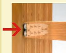
Der Sperrbügel aus federndem Edelstahl draht wird vor der Endmontage in die vorgesehene Öffnung eingeklippt und sichert die Verbindung automatisch entgegen der Einschubrichtung.
