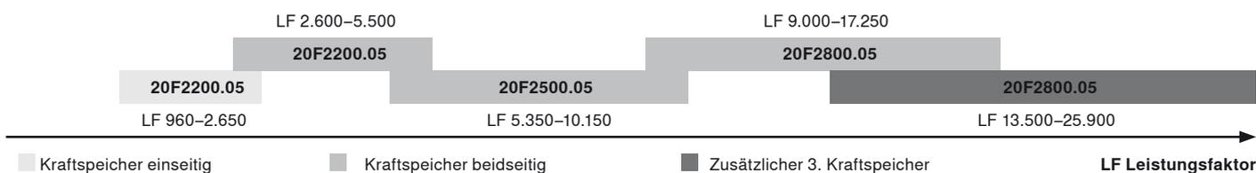
In den Randbereichen der einzelnen Kraftspeicher empfehlen wir einen Anschlagversuch!
