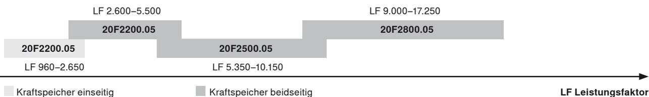
In den Randbereichen der einzelnen Kraftspeicher empfehlen wir einen Anschlagversuch!
