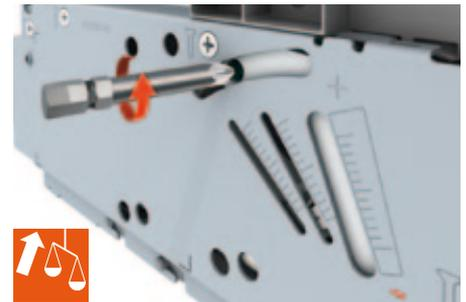
**1.** Die Kraftspeicher werden stufenlos mittels Akkuschauber (Pozidriv®, Größe 2, Länge 39 mm) auf das jeweilige Frontgewicht eingestellt.
