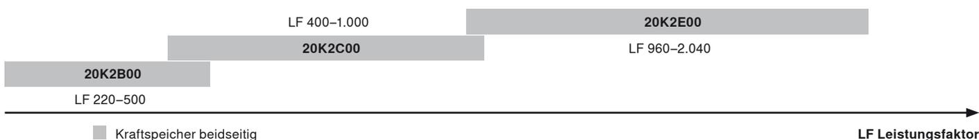
In den Randbereichen der einzelnen Kraftspeicher empfehlen wir einen Anschlagversuch!
