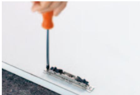
**2.** Die symmetrische Frontbefestigung wird auf der Front angebracht.
