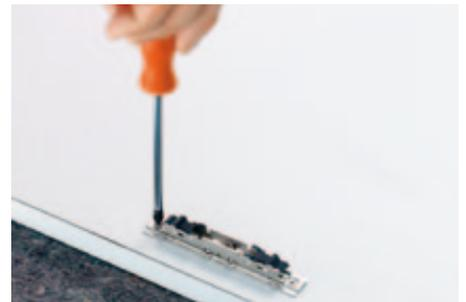
3. Die symmetrische Frontbefestigung wird auf der Front angebracht.
