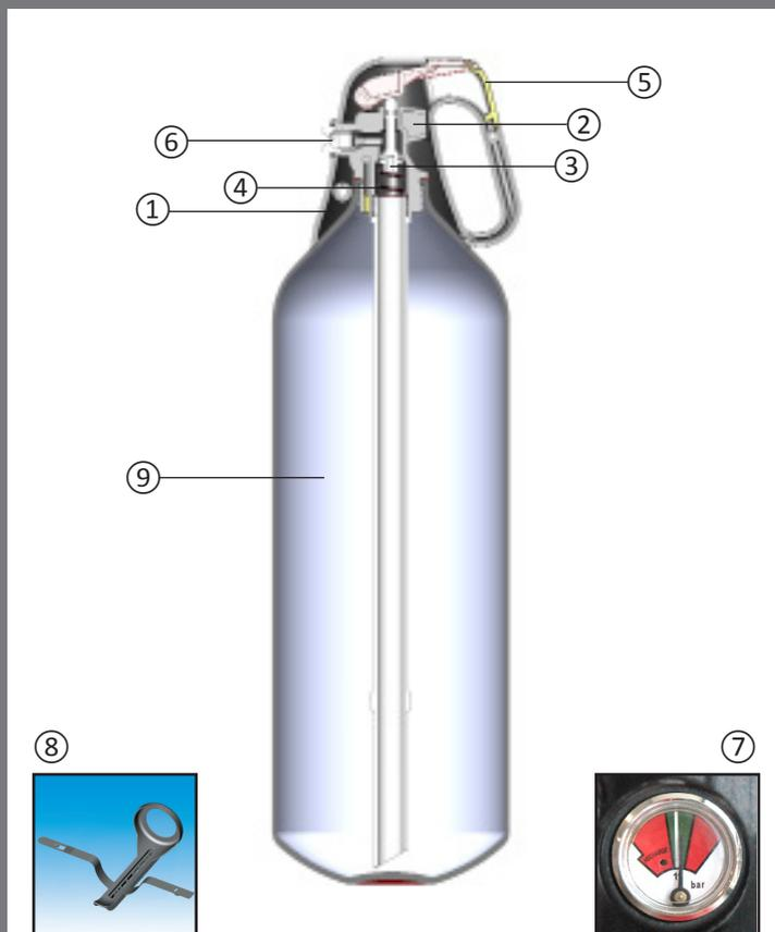
① Der handlich- kompakte Ventilblock ist ergonomisch gestaltet, um eine einfache Handhabung mit einer Hand zu gewährleisten. Das Material der Kappe, aus hochfestem Kunststoff, sorgt für einen perfekten Korrosionsschutz. Der Tragegriff ist mit klar gekennzeichneten Bedienelementen versehen:
