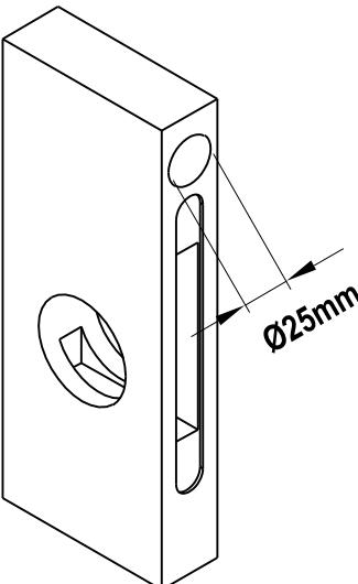
Fräsen sie an der Stirnseite der Tür mit einem Durchmesser von Ø25mm, ein 25mm tiefes Loch für die Fingerschale. Auf Kundenwunsch können Sie die Fingerschale versetzen. Die Maße betragen Ø29mm x 1,6mm (Eckige Version 29mm x 29mm x 1,6mm)
