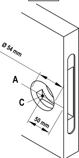
Fräsen Sie ein Loch (Ø54mm) halb durch die Tür von beiden Seiten um eine Beschädigung durch Splittern zu vermeiden.
