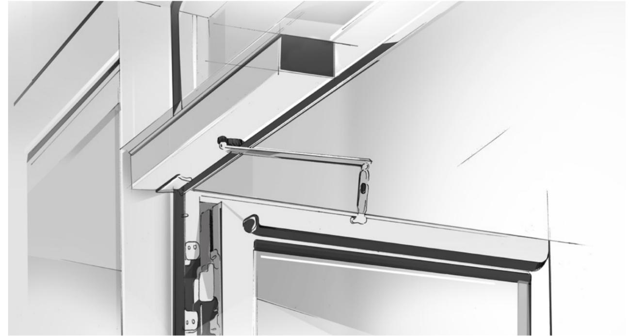
Beispielhafter elektromotorischer Antrieb mit Sensorleisten.
