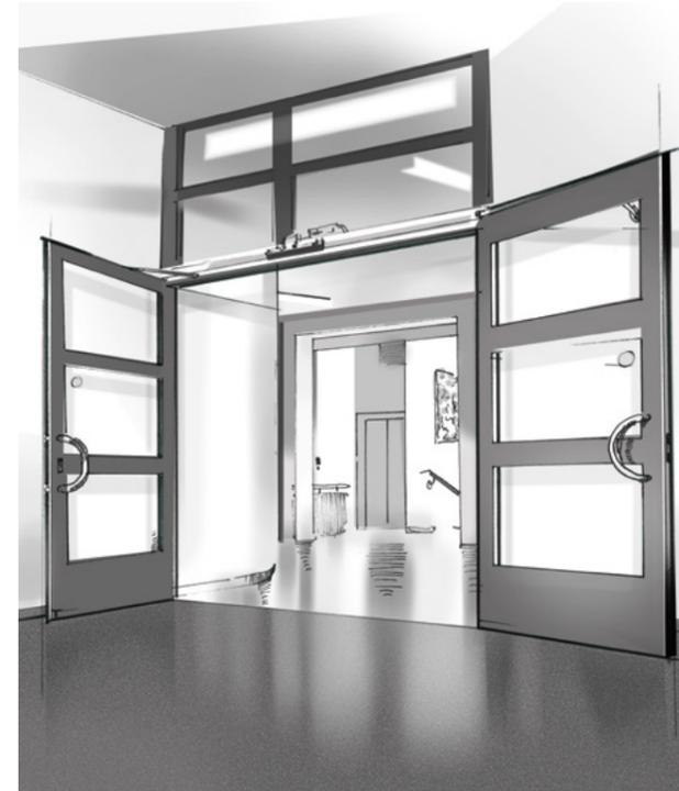
Beispielhafter Aufbau einer Brandschutztür mit Feststellanlage.
