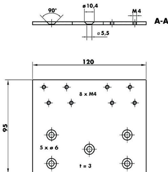
Montageplatte für senkrechte Montage des Türdämpfers V 1600 an Brandschutztüren
