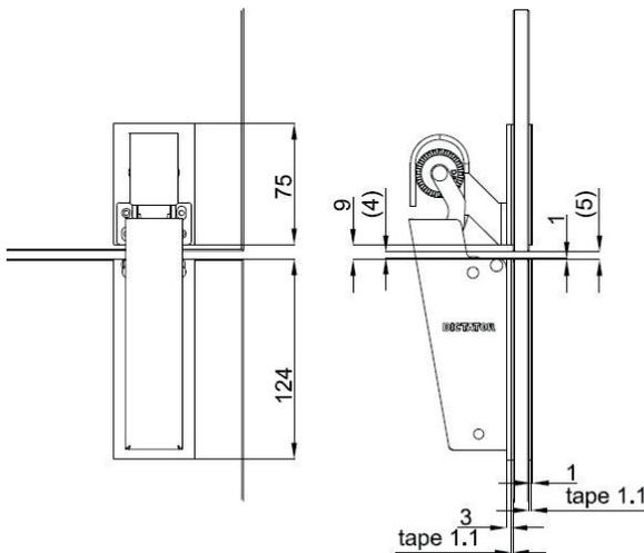
Mit Hilfe eines speziellen doppelseitigen Klebebandes werden die Montageplatten sowohl für den Türdämpfer V 1600 als auch für den dazugehörigen Haken auf der Glastür bzw. dem Glas-Oberlicht befestigt. Zur Abrundung des optischen Erscheinungsbildes gehört zu jedem Set jeweils eine Abdeckplatte, die ebenfalls mit Klebeband auf der anderen Türseite genau auf die Position der Montageplatte geklebt wird. Sowohl Montage- als auch Abdeckplatten sind aus V2A.
