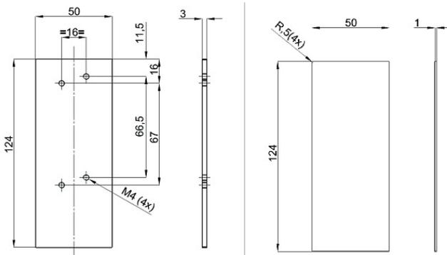
**Montageplatte und Abdeckplatte zum Kleben für den Haken**
