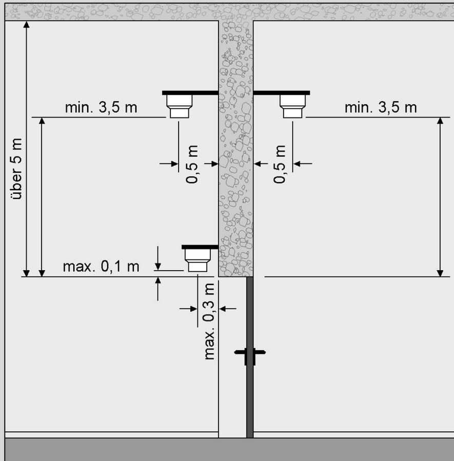
Ist der Abstand der Decke von der Oberkante der Wandöffnung größer als 5 m, dann dürfen zugehörige Deckenmelder durch Melder ersetzt werden, die mindestens 3,5 m über der Oberkante der Wandöffnung und an einer Konsole von 0,5 m Länge angebracht sind.
