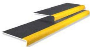
An jedem Ende der Antirutsch-Stufen ein Loch ca. 15 mm von der hinteren Kante und ca. 15 mm von der Seite entfernt bohren. Das zweite Loch sollte ca. 15 mm von der Seite entfernt auf der Linie gebohrt werden, wo der schwarze Treppentritt auf die gelbe oder weiße Treppenkante trifft. Die Antirutsch-Stufen müssen in der Mitte des Stufentritts wahrscheinlich nicht zusätzlich befestigt werden (es sei denn, die Stufe ist mehr als 2000 mm lang).
