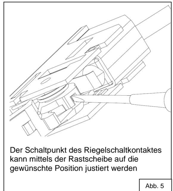
Der Schaltpunkt des Riegelschaltkontaktes kann mittels der Rastscheibe auf die gewünschte Position justiert werden
