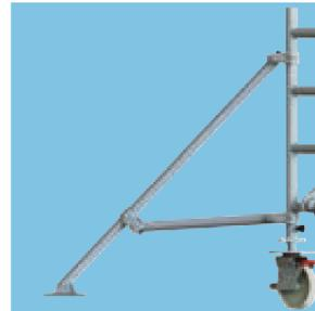
Bis Arbeitshöhe 8.40 m können die Fahrrollen durch 4 Ausleger kurz ersetzt werden.
