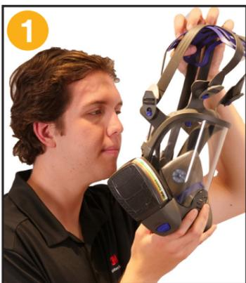
1. Lösen Sie alle sechs Kopfbänder vollständig. Halten Sie die Vorderseite der Atemschutzmaske mit einer Hand und die Gurte/das Comfort-Kopfband mit der anderen Hand von der Atemschutzmaske weg, um eine Öffnung für Ihren Kopf zu schaffen. Ziehen Sie das Atemschutzgerät nach unten über Ihren Kopf. Platzieren Sie Ihre Nase in der Innenmaske und Ihr Kinn in den Kinnschutzbereich. Drücken Sie dann die Atemschutzmaske fest und gleichmäßig gegen Ihr Gesicht.
