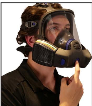
Drücken Sie leicht auf den Dichtheitskontrollknopf, bis Sie einen Widerstand spüren. Halten Sie den Knopf in dieser Position und atmen Sie aus (pusten Sie). Wenn sich die Atemschutzmaske leicht aufwölbt und zwischen dem Gesicht und der Maske kein Luftaustritt feststellbar ist, wurde ein korrekter Dichtheitsitz erreicht.
